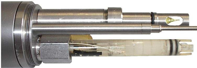
Sonde ohne Schutzkorb mit Sensoren für H<sub>2</sub>S, pH, Temperatur und Tiefe.
